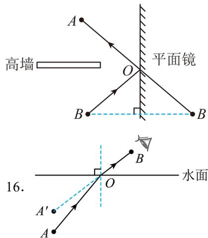
【详解】加水后，在 B 处看到的 A' 处的硬币的像，是硬币的光斜射向空气时，发生折射形成的虚像。眼睛逆着折射光线看时，觉得硬币变浅了，所以连接  $A'B$  与水面相交于  $O$ ， $O$  点为入射点， $OB$  为折射光线，过  $O$  作法线，据：光从水中斜射向空气中时，折射角大于入射角，大致确定入射光线  $AO$  的位置。作图如下：
