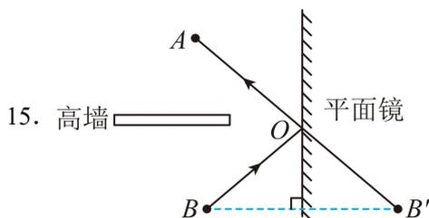
【详解】根据平面镜成像的特点，物与像关于镜面对称，可确定 B 的像的位置  $B'$ ，根据平面镜成像的原因，所以反射光线的反向延长线过像点，连接  $AB'$  与平面镜交于一点  $O$ ，连接  $AO$ 、 $BO$  即可，如图所示：
